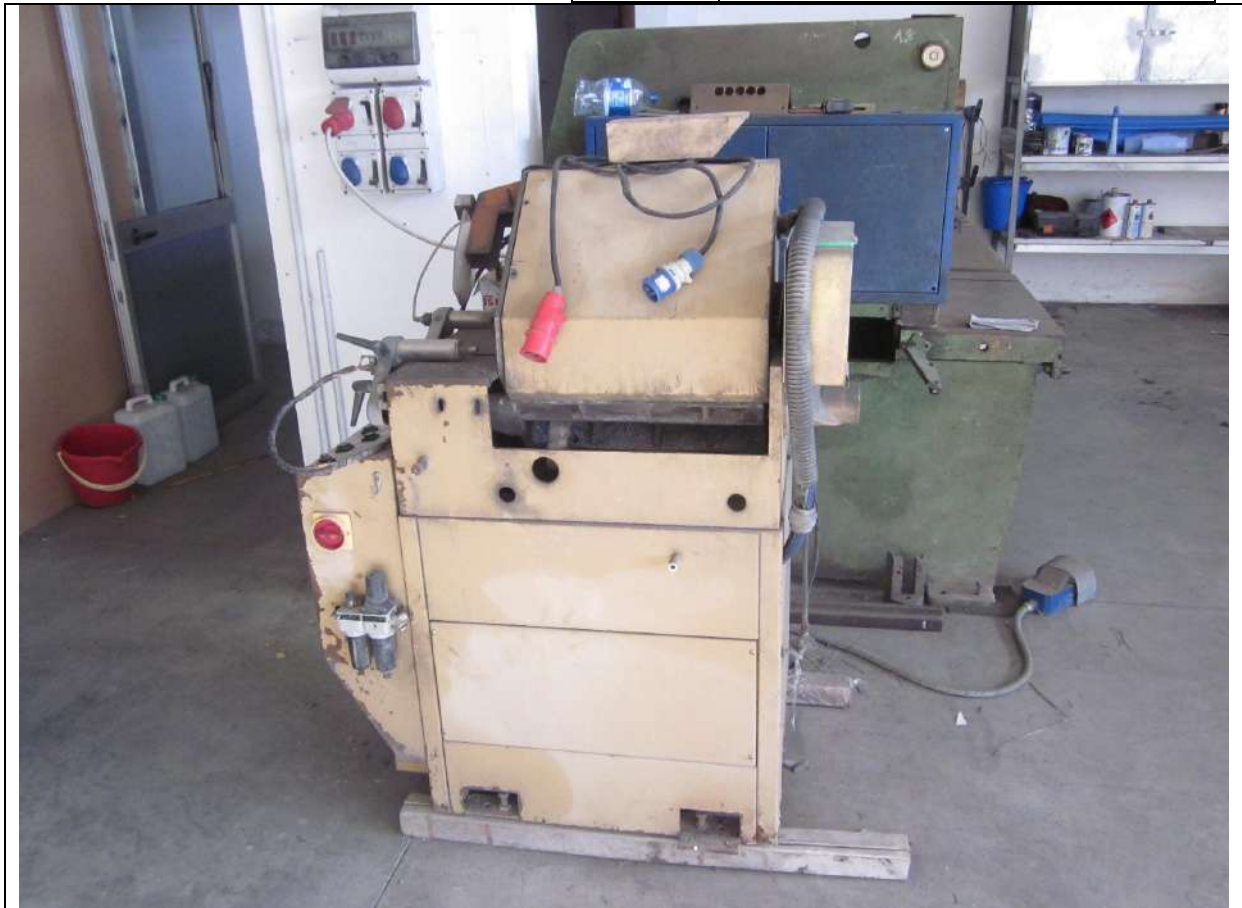
Troncatrice professionale per alluminio monotesta con lama a scomparsa per tagli a -45° 90° +45°
